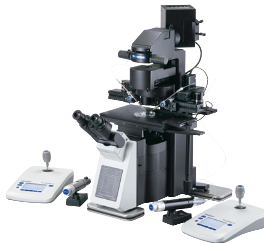
Рабочая станция для переноса стволовых клеток, переноса ядра или ИКСИ на клетках животных
